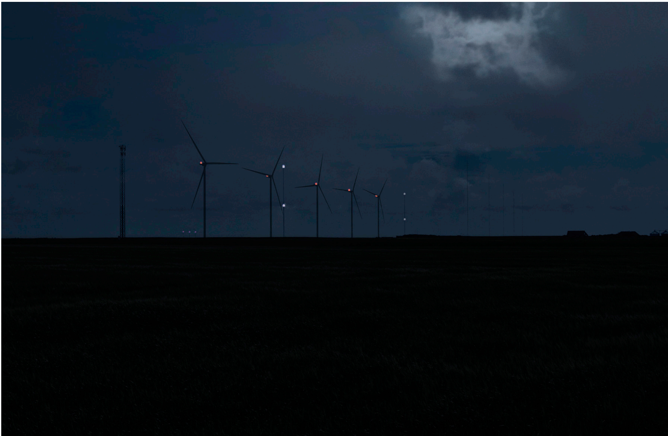
3: Fjaltring Nat Visualisering af fremtidige forhold (fem ens vindmøller). Navnhøjde 165 (maks), rotordiameter 220, totalhøjde 275 (maks). Afstanden til nærmeste planlagte prototypevindmølle er ca. 2,2 km fra fotostandpunktet.
