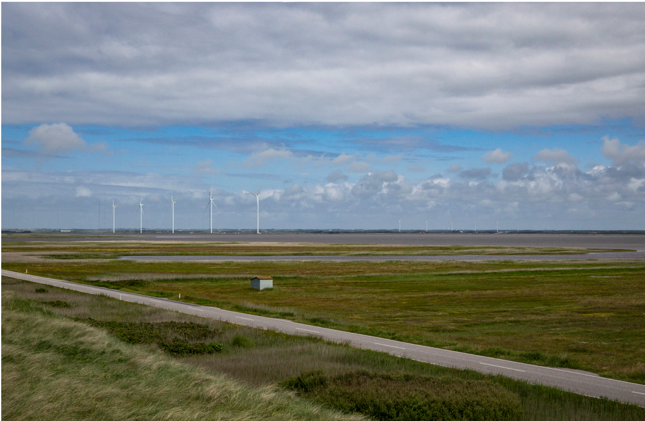
9: Bøvling Klit Visualisering af fremtidige forhold (fem ens vindmøller). Navnhøjde 145, rotordiameter 260 (maks), totalhøjde 275 (maks). Afstanden til nærmeste planlagte prototypevindmølle er ca. 5,9 km fra fotostandpunktet.
